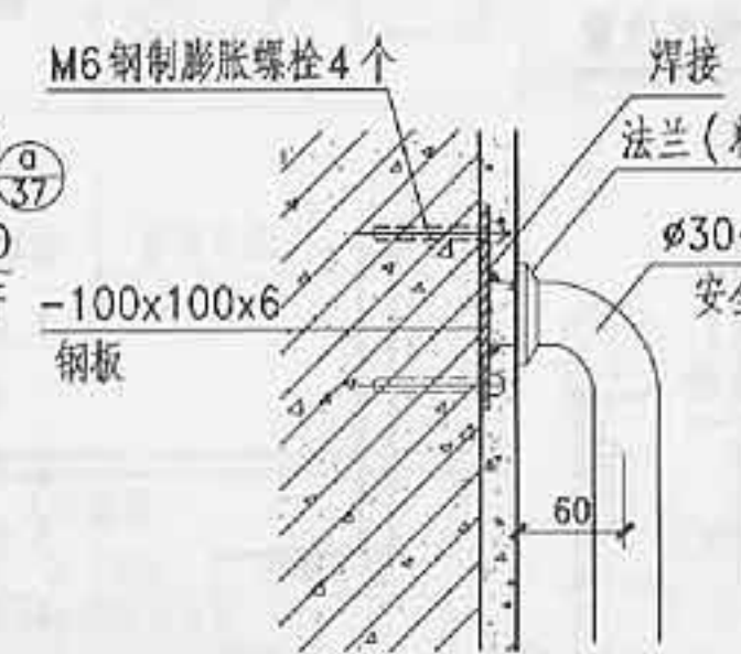
④ 混凝土墙安全抓杆做法
