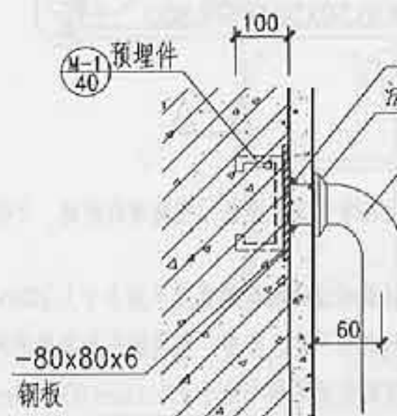
③ 混凝土墙安全抓杆做法
